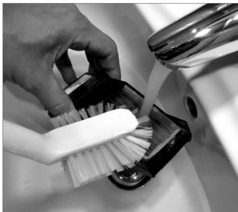
Reinigen des Wärmetauschers
